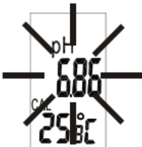
5. Если электрод поврежден или номинал калибровочного раствора не определен, основной ЖК-дисплей будет мигать, пока вы не выключите измеритель.
